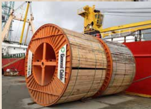
Kabel for lasting til Tosoya og Korsho Imene som var pioneranlegg for høyspent strømforsyning. Bygget av Elektro Team AS for utleie til Marine Harvest
